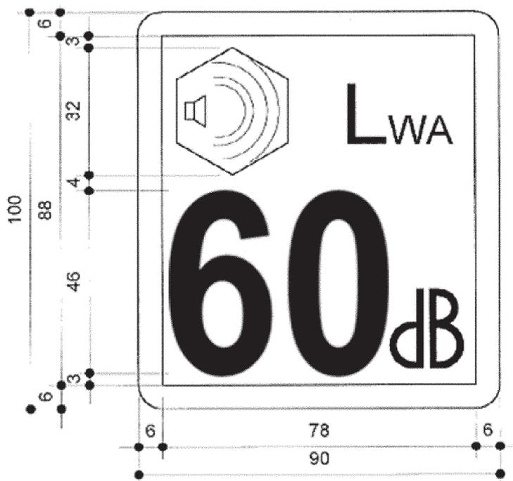
Bei Verkleinerung der Kennzeichnung je nach Größe des Geräts müssen die sich aus der obigen Zeichnung ergebenden Proportionen eingehalten werden. Die Höhe der Kennzeichnung sollte jedoch, soweit möglich, mindestens 20 mm betragen.
